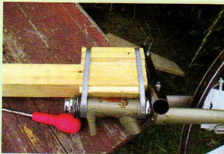
Fig. 6: La turbina è assicurata al palo di sostegno mediante fascette metalliche a vite.
