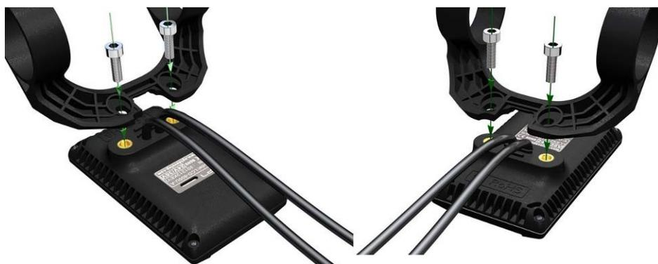
I morsetti sono adatti per 3 taglie del manubrio, 31.8mm, 25.4mm, 22.2mm, ci sono degli anelli adattatori di 25.4mm e 22.2mm. Gli anelli adattatori devono essere montati con una direzione obbligatoria, presta attenzione alla freccia verde di sotto.
