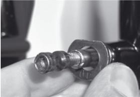
3. Inserire la rondella dedicata nel Pivot con vite di chiusura montata, posizionandola con la parte smussata nella zona superiore del Pivot **Achtung /Attenzione: utilizzare una sola rondella dedicata nel Pivot!**
