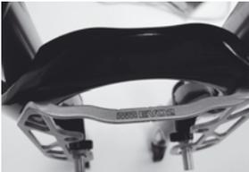
6. La staffa di montaggio EVO2 deve essere montato con la scritta ubicata sull'archetto superiore rivolta verso il montatore (assolutamente non deve risultare leggibile dal montatore al rovescio). **In riferimento alla figura riportata qui affianco, per una migliore visione nel dettaglio è stata montata una ruota non completa, quindi si avvisa che il montaggio dei freni può essere fatto anche con ruote complete!**
