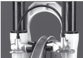
**2. Chiudere il bloccaggio rapido:** Spingere il pistoncino verso la forcella e chiudere la leva con la stessa operazione. E' fatta! **Con la tecnologia FIRM-tech non vi è alcuna necessità di utilizzare staffe di rinforzo.**
