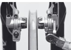
13. Il pretensionamento dello sgancio rapido, per regolarne la durezza di apertura e chiusura, deve essere effettuato agendo sul perno di chiusura dello stesso con lo sgancio rapido in posizione chiusa.
