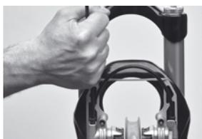
10. Controllare sempre la corretta installazione del tubo tirandolo e verificando che non vi siano perdite di olio dalle connessioni attivando la leva.
