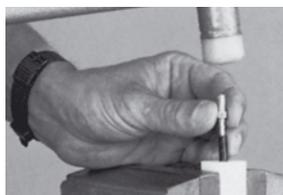
2. Per fare quest'operazione fissate il tubo nella morsa con gli appositi morsetti in dotazione. 15 mm di tubo devono fuoriuscire dalla morsa per potere introdurre l'inseritore.
