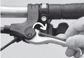
2. Recuperare l'usura dei pattini. **HS 11**. Girare la vite a brugola da 4 mm in senso orario.
