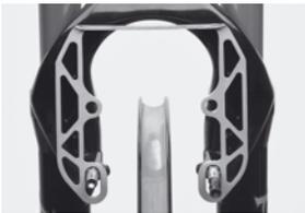
5. Inserire la staffa di montaggio EVO 2 nei Pivots
