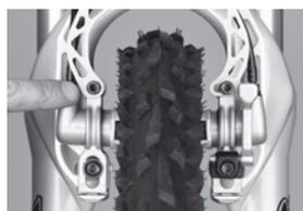
**14. Montaggio della staffa di rinforzo (Brake Booster)**
