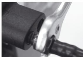
3. Avvitare ora il tubo con l'inseritore nel pompante.
