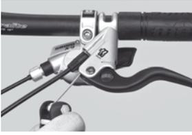
**15.** Per effettuare il **registro di allontanamento ed avvicinamento della leva** al Manubrio (solo per versione HS33) utilizzare chiave Allen SW2 (brugola). Ruotare in senso orario; la leva si avvicina al manubrio. Ruotare in senso antiorario: la leva si allontana dal manubrio.
