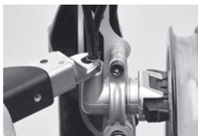
9. ATTENZIONE alle filettature. Iniziate ad avvitare il dado da 8 mm a mano e poi con la chiave. **(Coppia di serraggio 4 Nm)**.
