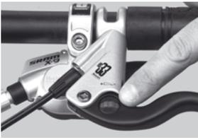
1. **Modelli HS 33.**(TPA) Turbo Pad Adjuster, colore rosso, ruotare la rotellina rossa in direzione segno " - ". Eventualmente allentare in senso antiorario anche il registro della leva (chiave Allen/brugola SW2)
