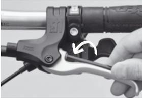
2. **HS 11.** Girare **completamente** la vite a brugola da 4 mm in senso antiorario.
