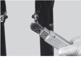
2. Vite di chiusura sgancio rapido **LEGERAMENTE** da avvitare nel Pivot sinistro della ruota anteriore, in riferimento alla posizione di guida, e nel Pivot destro per la ruota posteriore. **Si faccia attenzione al punto 13 della prossima pagina.**
