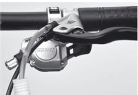
6. Si noteranno piccole bolle d'aria nel condotto di spurgo. Lo spurgo è completo quando dal condotto di spurgo non escono più bolle d'aria. Togliere il condotto di spurgo e riavvitare la vite di spurgo (**coppia di serraggio 4 Nm**). Togliere il condotto con la siringa e riavvitare la vite di spurgo (**coppia di serraggio 4 Nm**). Riportare le leva il posizione di utilizzo e fissarla (**coppia di serraggio 4 Nm**).
