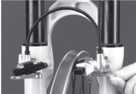
**1. Il doppio sblocco rapido** garantisce il massimo comfort. Per **aprire** ruotare la leva del bloccaggio verso la ruota e; ora si può spostare il pistoncino per rimuovere la ruota o sostituire i pattini.
