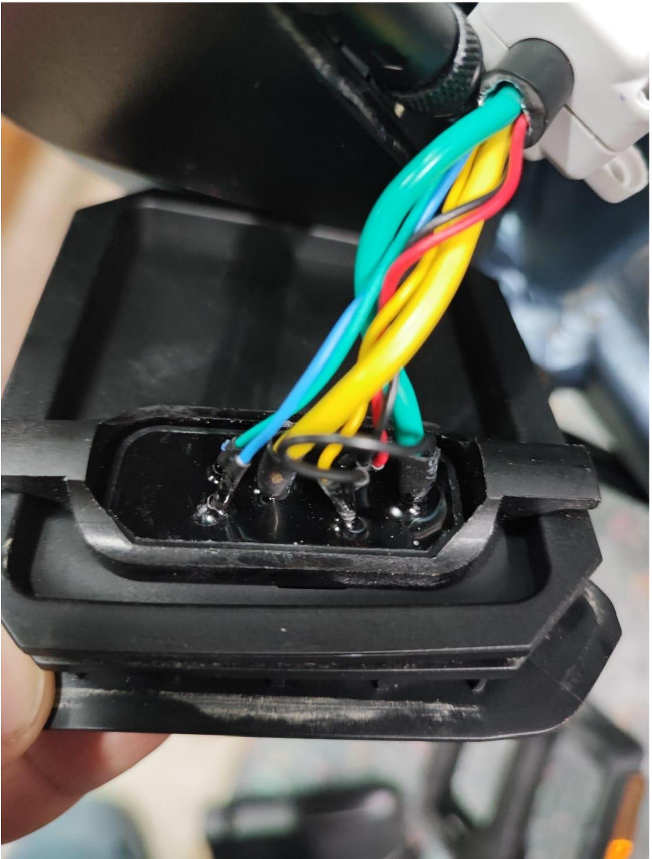
Collegamento della vecchia centralina al connettore della batteria
