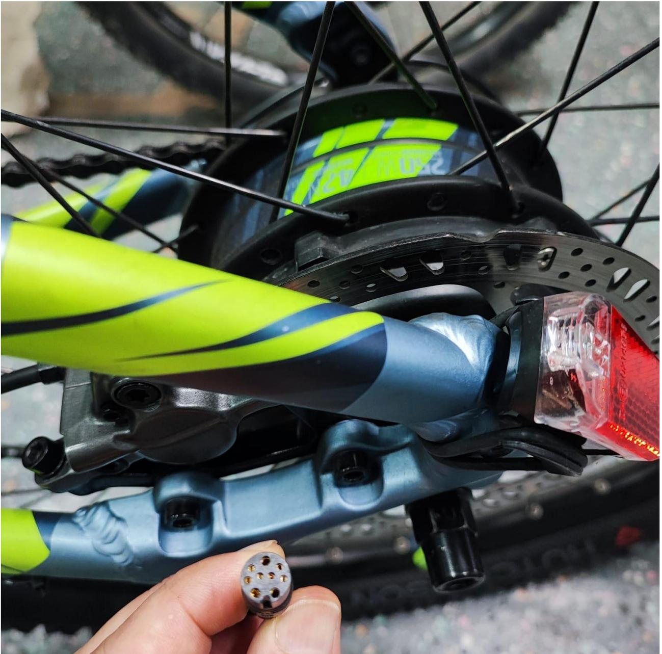
Connettore motore posteriore 250W 42Nm
