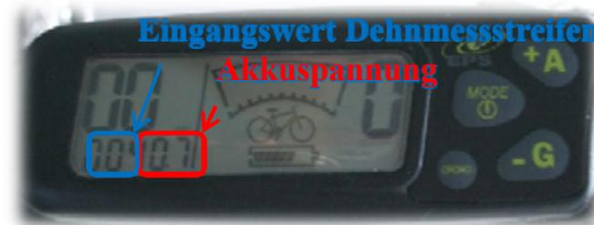
Die Akkuspannung sollte im VOLL-Zustand des Akkus einen Wert größer 40,0V einnehmen (bei neuwertigen Akkus)
