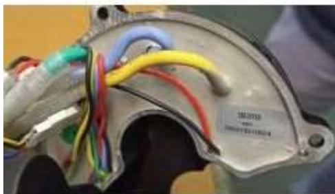
Il controller del motore fa parte dell'alloggiamento. Ciò faciliterà un'eventuale sostituzione. Migliorerà anche il suo raffreddamento. L'elettronica è riempita di mastice.
