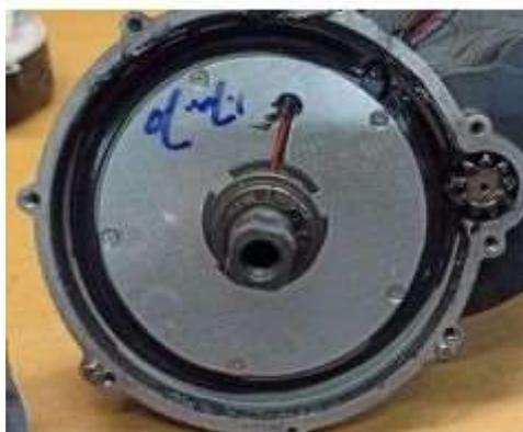
L'alloggiamento è dotato di perni di posizionamento sui giunti. È più facile collegare gli elementi dell'alloggiamento e grazie a ciò si adattano meglio.
