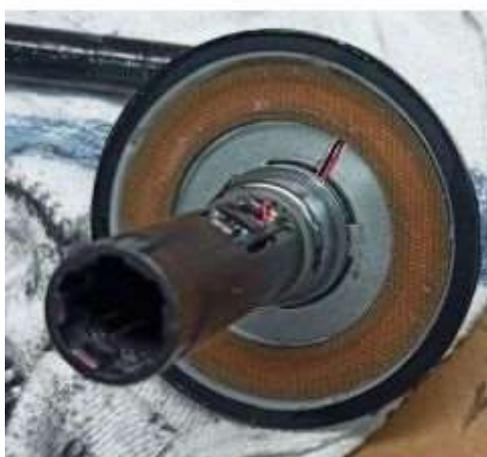
Il sensore di pressione ha una struttura simile a quella del TSDZ2. Tuttavia, all'interno è stato aggiunto un cuscinetto reggispinta al posto delle rondelle in Teflon.
