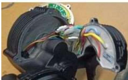
I componenti dell'alloggiamento sono sigillati da rondelle di carta anziché da guarnizioni in gomma. Suscettibile di danni quando smontato.
