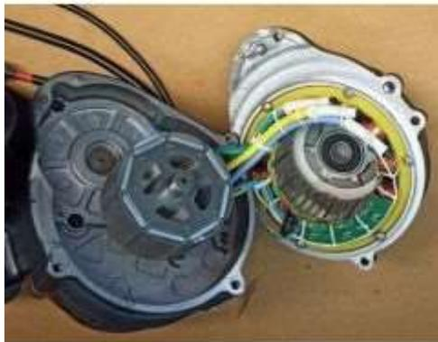
Lo statore del motore elettrico è parte integrante dell'alloggiamento. Non ci sono problemi con la dissipazione del calore verso l'alloggiamento.
