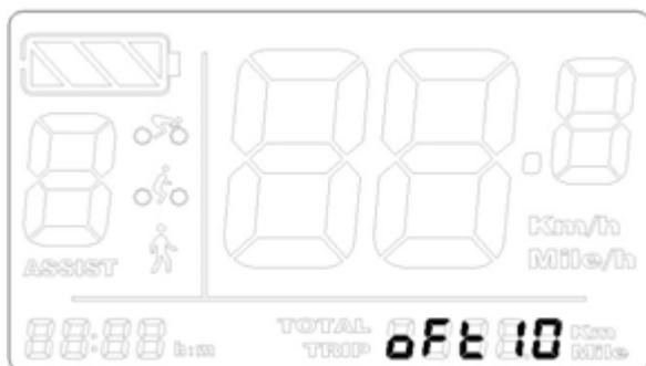
Il display e il motore si spengono se non viene effettuata alcuna operazione entro il tempo impostato. Premere
