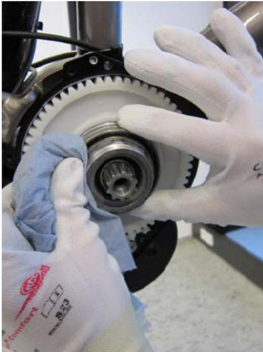
**Bild 9:** Lager auf der Tretlagerwelle mit sauberem Lappen reinigen, ebenso die Auflagefläche der Dichtung am Motorgehäuse
