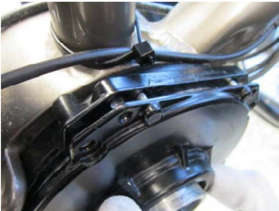
**Bild 12:** Motorgehäusedeckel senkrecht auf das Lager aufsetzen. Verkanten vermeiden. Zentrierzapfen des Deckels in die dazugehörigen Bohrungen des Gehäuses einführen.
