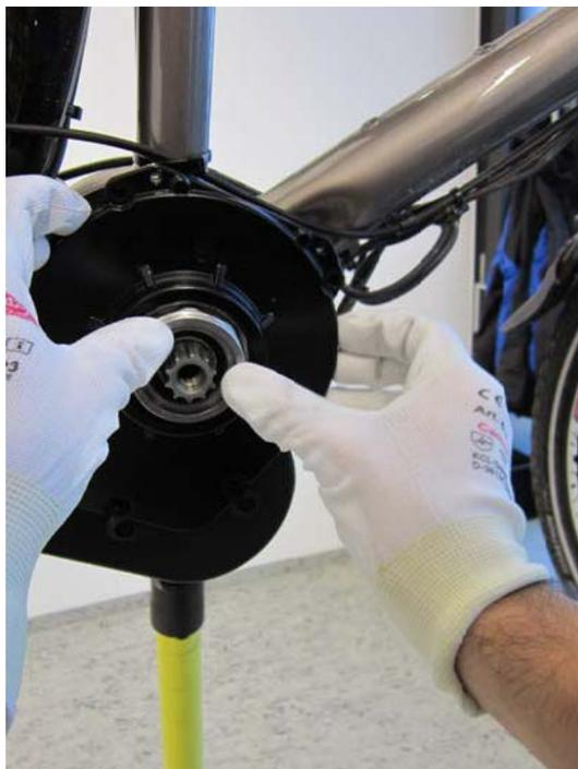
**Bild 5:** Motorgehäusedeckel wie gezeigt abnehmen. Hände umgreifen den Deckel, Daumen stützen sich auf Welle oder Tretlagergehäuse wie gezeigt ab. Darauf achten, den Deckel beim Abnehmen NICHT zu verkanten. Keinen Schraubendreher oder Reifenheber verwenden, Dichtung des Deckels könnte irreparabel beschädigt werden!
