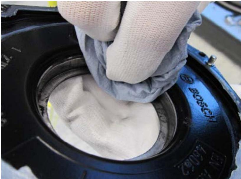
**Bild 7:** Lagersitz im Deckel reinigen. Dabei Dichtung NICHT berühren oder mit Fett verunreinigen. Nur bei sichtbarer Verunreinigung Dichtung mit trockenem, sauberen, weichen Lappen ohne Druck abwischen.
