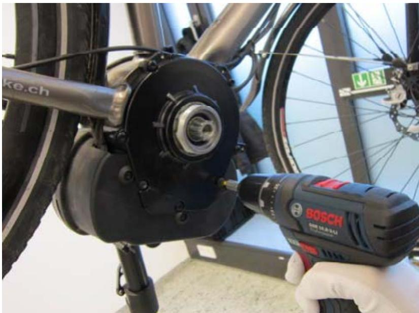
**Bild 3:** Rechten Motorgehäusedeckel öffnen. Hierzu 7 Torx T25 Schrauben entfernen
