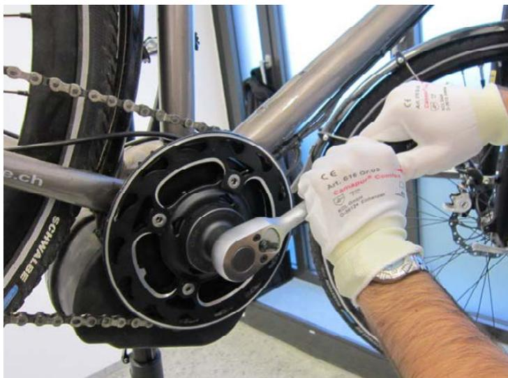
**Bild 1:** Akku entnehmen, eBike in Montageständer spannen, Demontage rechte Kurbel, Verschlussmutter (Linksgewinde, Bosch-Spider-Tool)
