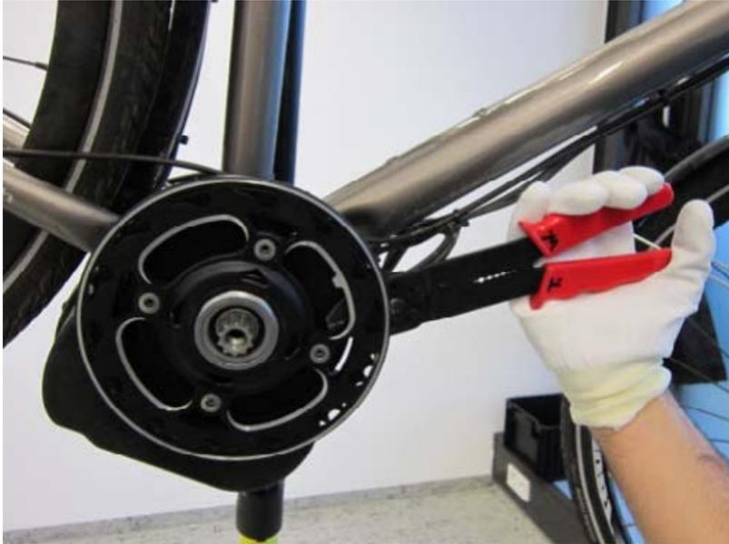
**Bild 2:** Spider mit Kettenblatt und Kette entnehmen, ggf. Pedalschlüssel oder anderes flach-stumpfes Werkzeug als Hebel verwenden
